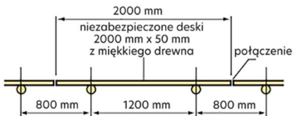
Rys. 74. Schemat deskowania krawędzi brzegu [Krukowski 2006]
